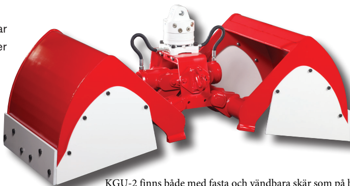
KGU-2 finns både med fasta och vändbara skär som på bild.
